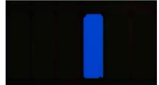
Erro de subpixel claro: Mancha clara em fundo preto causada por subpixel azul no estado "on".
