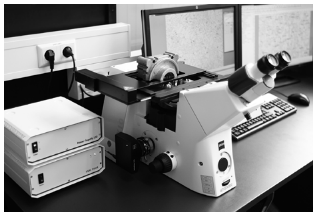
Abbildung 1 Gefügeanalyse an Makroschliffen größerer NE-Gussbauteile. Die inverse Bauform des Mikroskops macht die Durchführung von Analysen für Benutzer einfacher und schneller. Die Probentrennung und -einbettung kann entfallen, aufgelegte Proben befinden sich direkt in Schärfeebene und auch große und schwere Proben können direkt untersucht werden.
