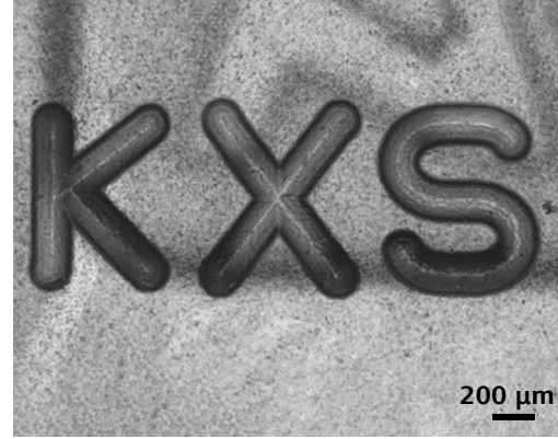
Şeffaf plastik kısımda enjeksiyon kalıplamalı tanımlama levhası, EC EPIPLAN 5x/0,13
