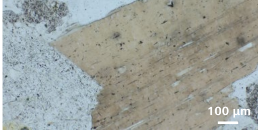
Granit içinde biyotit, alttan aydınlatma, aydınlık alan, EC Plan-NEOFLUAR 10x/0,3 Pol
