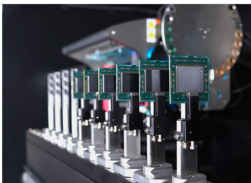
Autoloader のロボットを組み込んで、一度に多数の試料を数日間スキャンすることで、観察の自動化が可能に。
