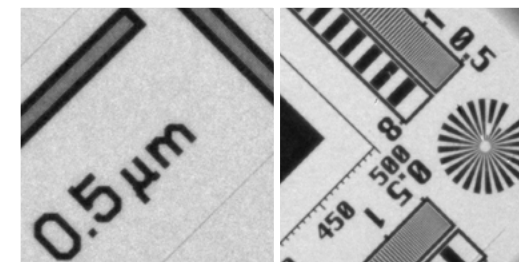
JIMA 分解能テストターゲットで示された 0.5 \mu\text{m} の空間分解能 (左)。ZEISS 分解能テストターゲットで示された 0.5 \mu\text{m} の空間分解能 (右)。
