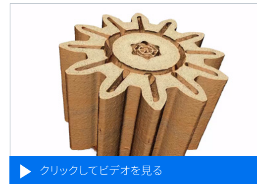
アディティブマニュファクチャリングで製造されたアルミニウム歯車の総合的な特性評価により、介在物や細孔、CAD モデルとの相対的な寸法の偏差が明らかに。試料ご提供：Timo Bernthaler, University of Aalen
