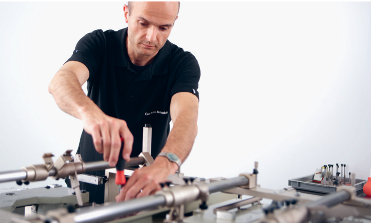
Bild 23 Herstellung mechanisch geteilter Gitter
