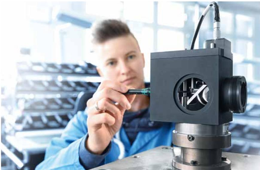
*Mit unserer digitalen Justage und der direkten Verknüpfung zum Optik-Design entstehen herausragende optische Module und Systeme. Durch die Integration von Systemmesstechnik in den Justageprozess stellen wir die berechnete Abbildungsgüte sicher und liefern auf Kundenwunsch die entsprechenden Protokolle.*
