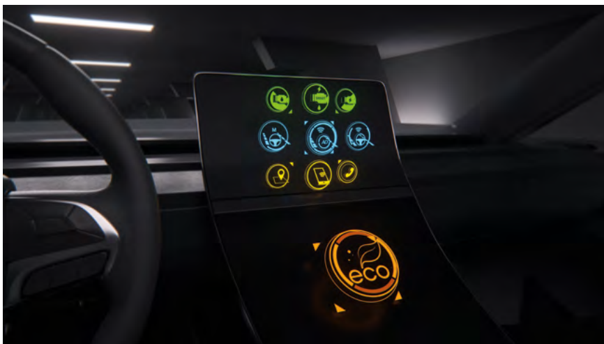
BILD 4 Ein Beispiel für holografische Schalter als Alternative zu klassischen 3-D-Bedienelementen: Die Aktivierung kann beispielsweise durch Sprachbefehl oder Gestensteuerung erfolgen (© Zeiss)
